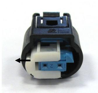
2. Original Leitung in die mitgelieferte Buchse mit Abdichtungen ganz einschieben und einrasten. Pinposition / Kabelfarbe ist nicht relevant. Anschließend Steckergehäuse verriegeln.
