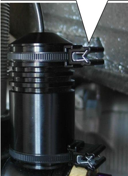
HA Elektronik Modul am Fahrzeugdom mit den mitgelieferten Klammern befestigen und in den Kabelbaum einstecken. Auf die korrekte Verriegelung des Steckers achten! Leitung mit Kabelbindern am Kabelbaum befestigen.
