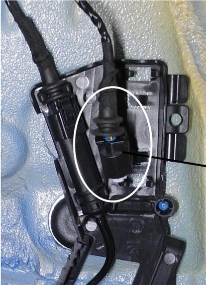
1. Steckersicherung öffnen und die originale Steuerleitung zum Dämpfer mit geeignetem Werkzeug aus der Buchse ausspinnen.
