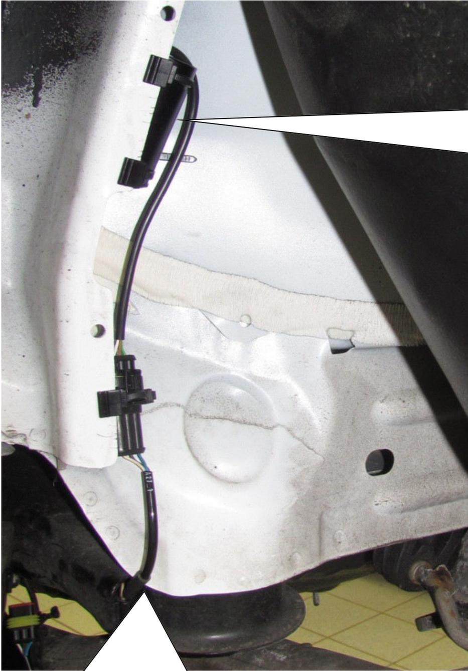
Die Stilllegung und den Adapterkabelbaum mit den mitgelieferten Klammern an der Karosseriekante befestigen.
