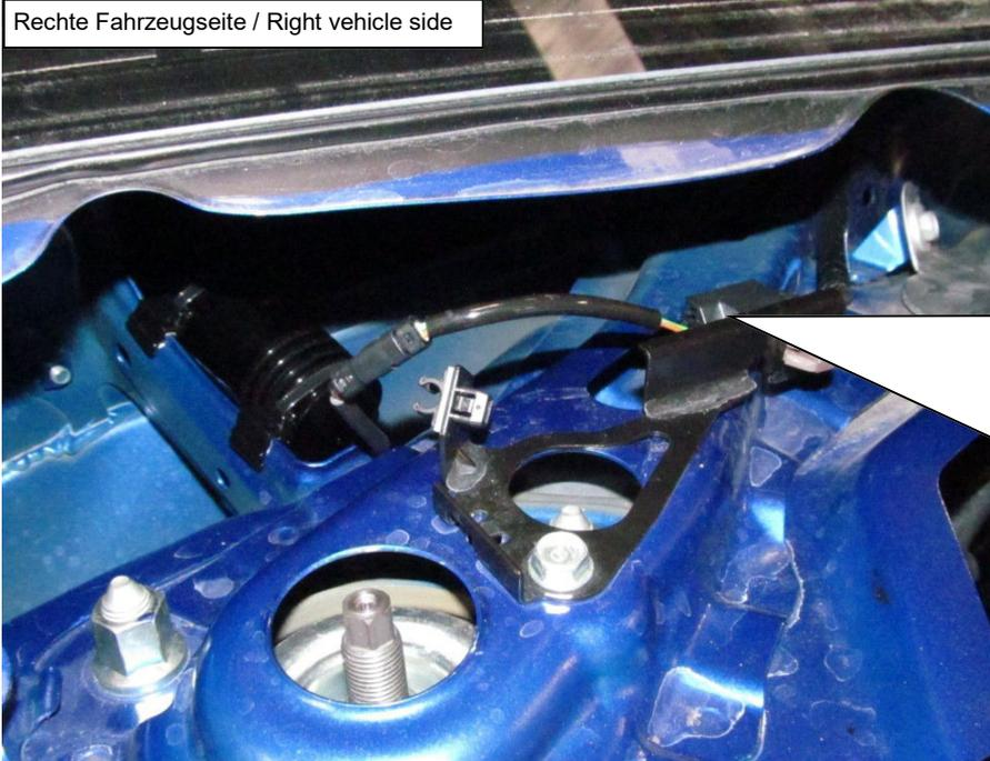
Die originale Dämpfersteuerungsleitung mittels Adapterkabel in die Stilllegung einstecken und diese mit den mitgelieferten Klammern an der Karosseriekante befestigen.
