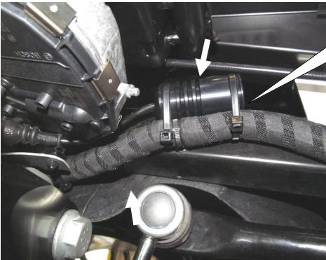
Die Leitung und Steckverbindung mit den mitgelieferten Kabelbindern befestigen.
