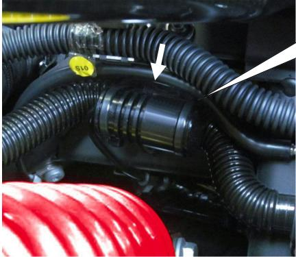
Die Leitung und Steckverbindung mit den mitgelieferten Kabelbindern befestigen.
