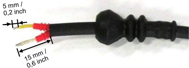
3. Den Pin-Kontakt mit einem geeignetem Werkzeug montieren.
