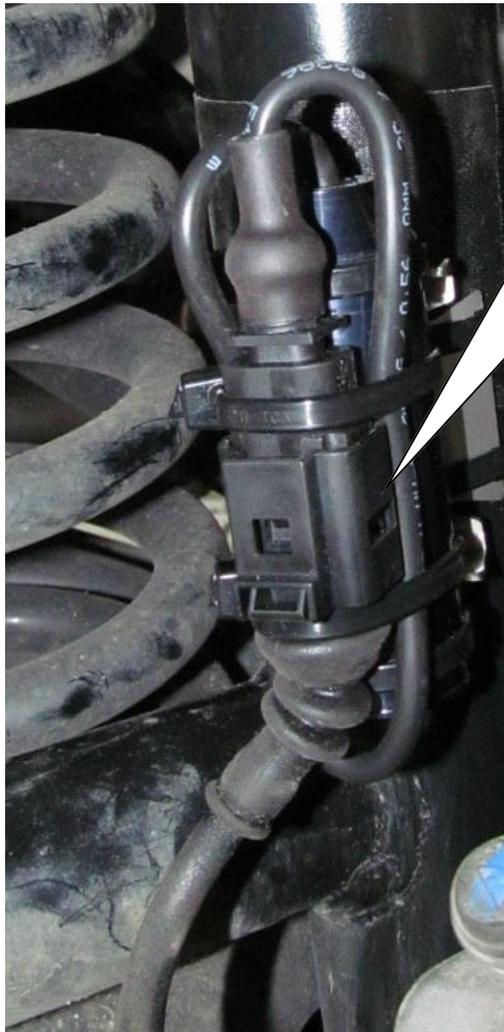
Der Stilllegungsstecker muss mit dem Originalstecker verbunden werden. Es muss zwingend auf die korrekte Verriegelung des Steckers geachtet werden! Anschließend wird die neue Leitung mittels der mitgelieferten Kabelbinder befestigen.
