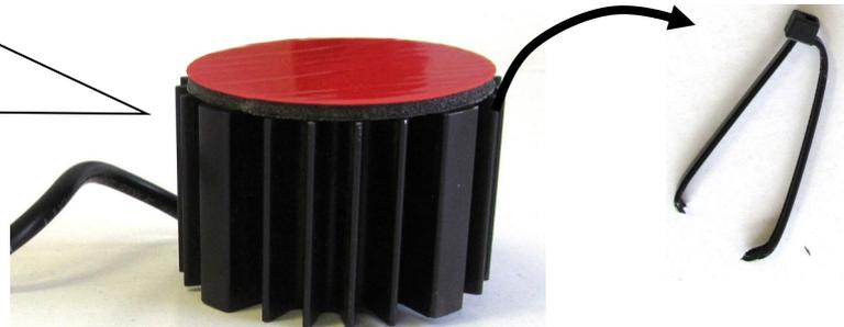
Die originale Dämpfersteuerungsleitung wird in die mitgelieferte Stilllegung eingesteckt. Es muss zwingend auf die korrekte Verriegelung des Steckers geachtet werden. Die Stilllegung wird anschließend mit dem Klebeband an der Fahrzeugkarosserie befestigt. Der Stecker muss zusätzlich, wie an der Vorderachse, mit einem Kabelbinder gesichert werden.
