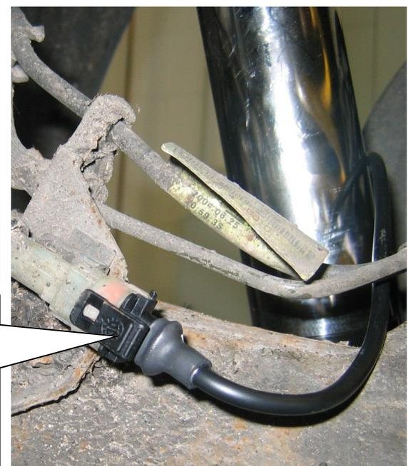
Der Stilllegungsstecker muss in die Originalbuchse eingesteckt werden. Es ist zwingend auf die korrekte Verriegelung des Steckers zu achten! Anschließend wird die originale Dämpfersteuerungsleitung mit den mitgelieferten Kabelbindern befestigt.
