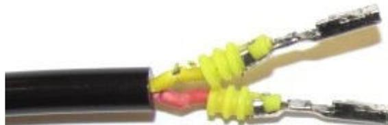
4. Die Steckersicherung muss geöffnet werden. Nun wird die abgedichtete Leitung vollständig in das Gehäuse eingeschoben, bis diese einrastet. Die Pinposition / Kabelfarbe ist in dem Fall nicht relevant. Anschließend wird das Steckergehäuse wieder verriegeln.
