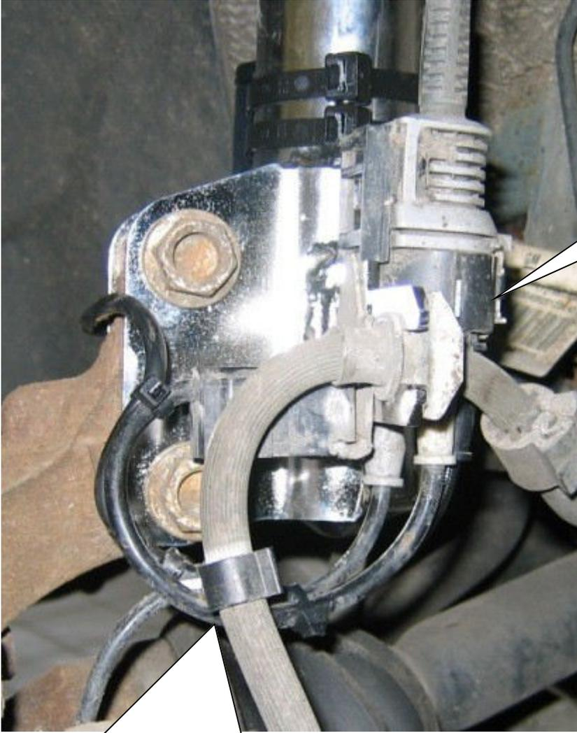
Der Stecker der Stilllegung wird in die Originalbuchse eingesteckt. Es ist hier zwingend auf die korrekte Verriegelung des Steckers zu achten! Anschließend wird die neue Leitung mittels der mitgelieferten Kabelbinder befestigt.
