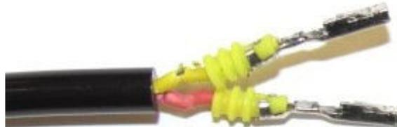
4. Die Steckersicherung muss geöffnet werden. Nun wird die abgedichtete Leitung vollständig in das Gehäuse eingeschoben, bis diese einrastet. Die Pinposition / Kabelfarbe ist in dem Fall nicht relevant. Anschließend wird das Steckergehäuse wieder verriegelt.
