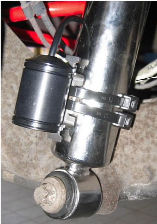
Die Stilllegung muss mit dem mitgelieferten Klebeband und Kabelbindern (4,8mm x 290mm) am Stoßdämpfer befestigt werden.
