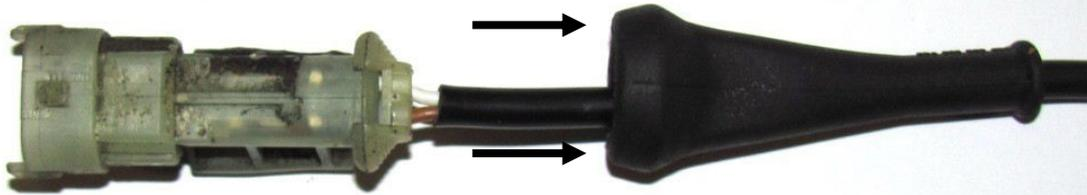
2. Öffnen Sie die Steckersicherung. Die originale Dämpferleitung muss mit geeignetem Werkzeug aus der Buchse ausgepinnt werden.
