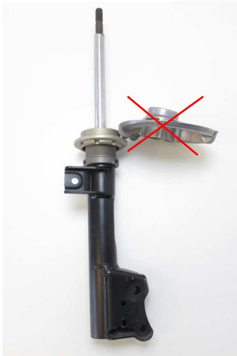
**Abb. 1:** Montage VA-Höhenverstellung
