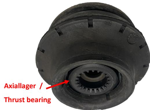
**Abb. 2:** Stützlager mit Axiallager
