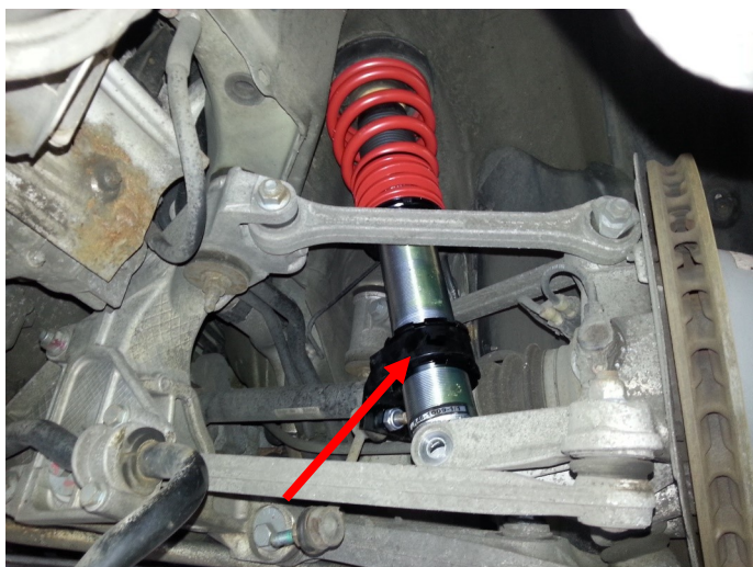
Abb. 1: Pendelstützenhalter HA Fig. 1: Sway bar link bracket rear axle
