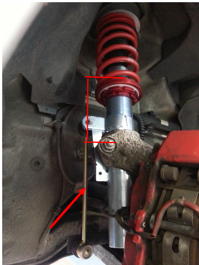
Abb. 2: Pendelstütze VA Carrera 4/Turbo Fig. 2: Sway bar link FA Carrera 4/Turbo
