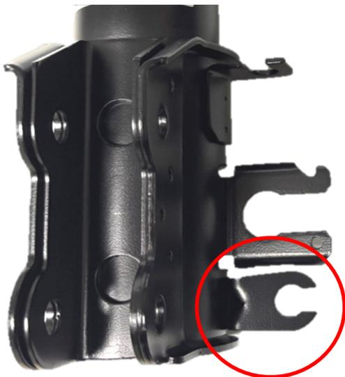
**Abb. 1:** Federbein rechts, mit Zusatzhalter
