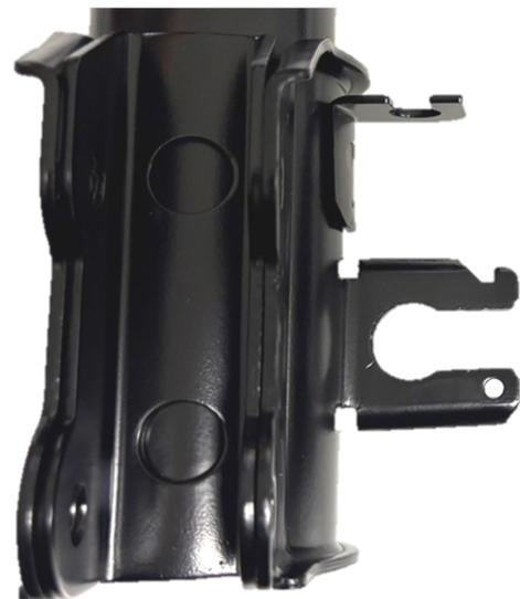
**Abb. 2:** Cup-Kit Federbein rechts, ohne Zusatzhalter
