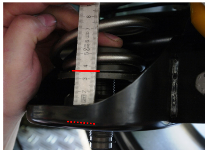
Abb. 5: Einstellmaß HA Fig. 5: Adjustment dimension RA
