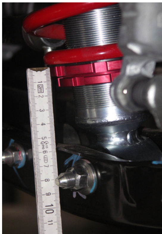
Bild 4 / Pic. 4: Einstellmaß HA / adjustment RA
