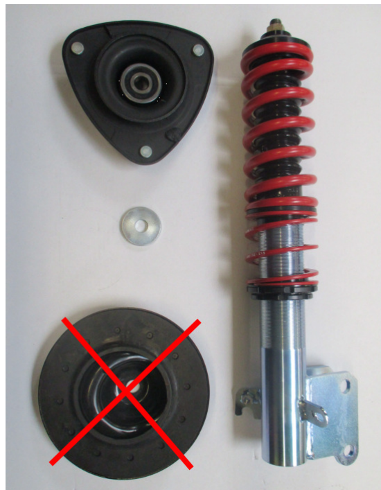
Bild 2 / Pic. 2: Nur bei / Only applicable for 28760-1 & RSS-46-760-5/1: Federteller entfällt / spring plate omits
