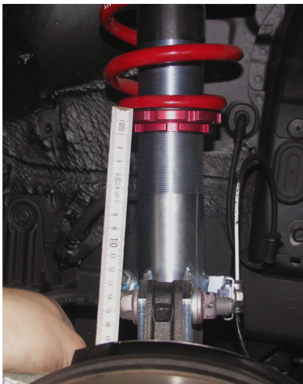
Bild 3 / Pic. 3: Einstellmaß VA / adjustment FA (Bild zeigt / Pic. shows 29040-1)
