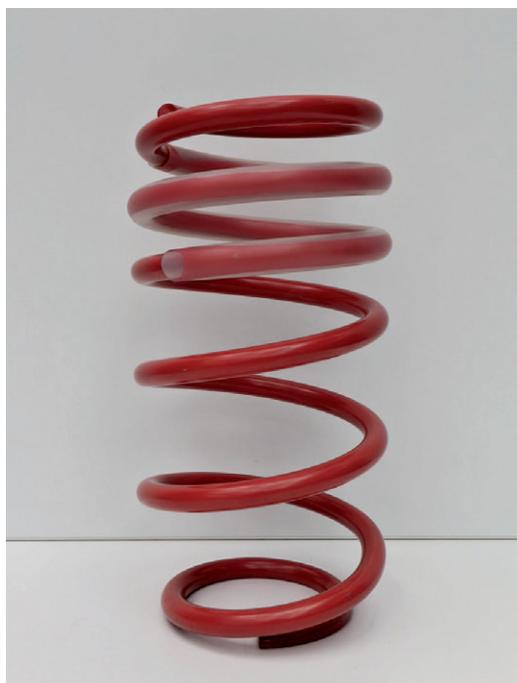
Fahrerseite: das untere Federende zeigt zum Fahrzeugheck
