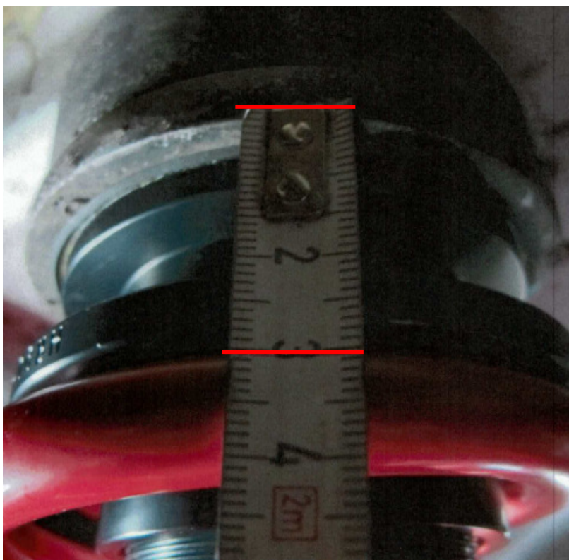
Abb. 4: Einstellmaß HA (Abb. ähnlich) Fig. 4: adjustment dimension RA (Picture may vary)
