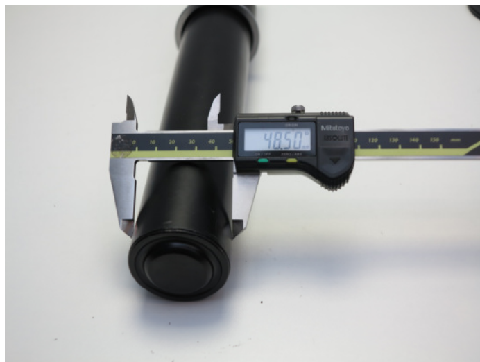
Abb. 2: VA-Dämpfer Durchmesser 48,5 mm Fig. 2: FA shock absorber diameter 48,5 mm
