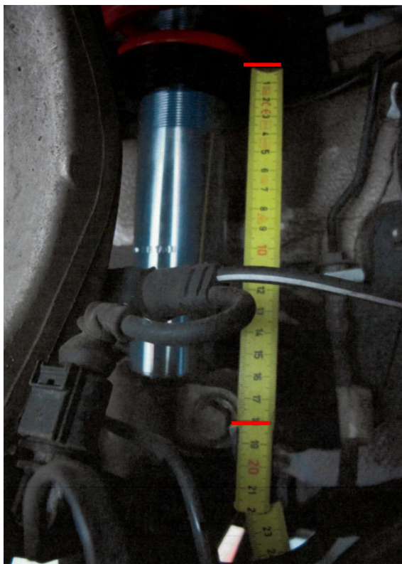
Abb. 3: Einstellmaß VA (Abb. ähnlich) Fig. 3: adj. dim. FA (Picture may vary)
