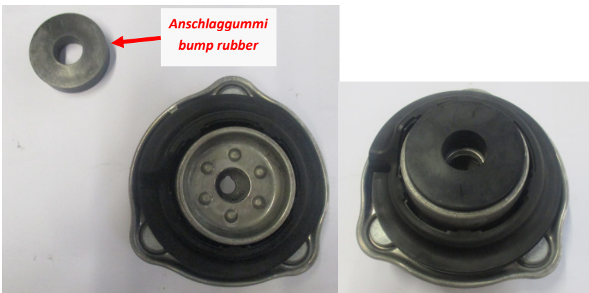
Bild 2: VA - Anschlaggummi einsetzen
