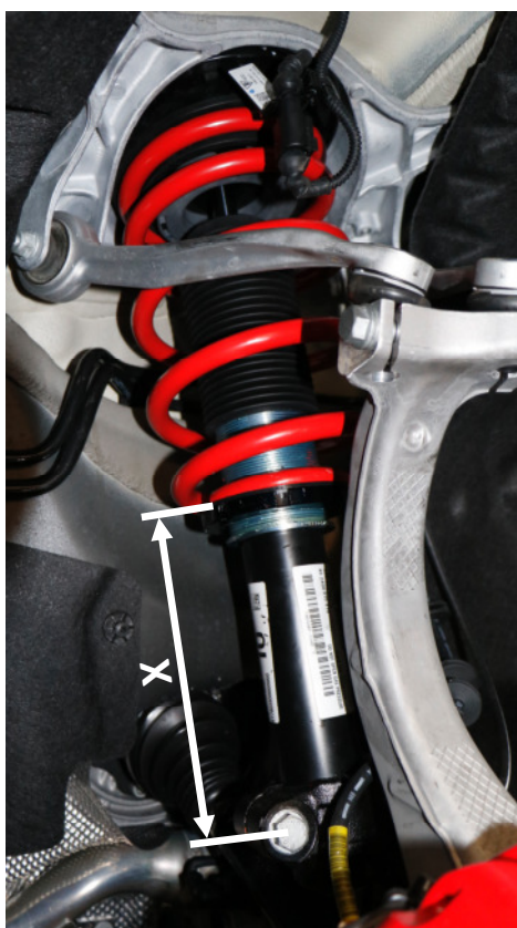
Abb. 4: Einstellmaß X VA (Abbildung ähnlich) Fig. 4: Adjustment dimension X FA (Fig. may vary)
