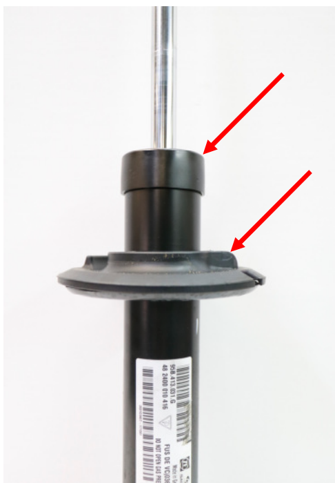
Abb. 1: Abdeckkappe und Federteller demontieren Fig 1: Dismantle cap and spring plate
