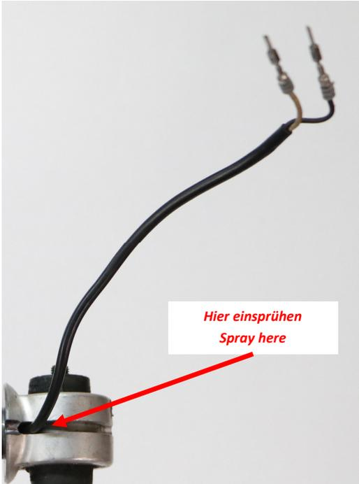
**Abb. 1:** Demontierter Stecker
