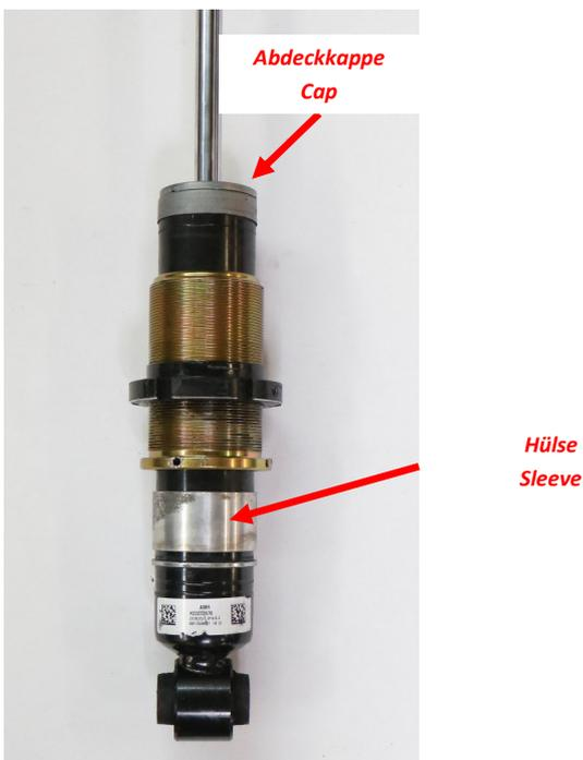
**Abb. 8:** Hülse, Höhenverstellung und Abdeckkappe montieren
