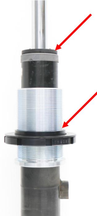
**Abb. 1:** Abdeckkappe und Federteller demontieren
