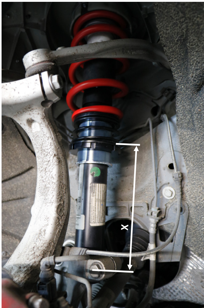
Abb. 4: Einstellmaß X VA (Abbildung ähnlich)
