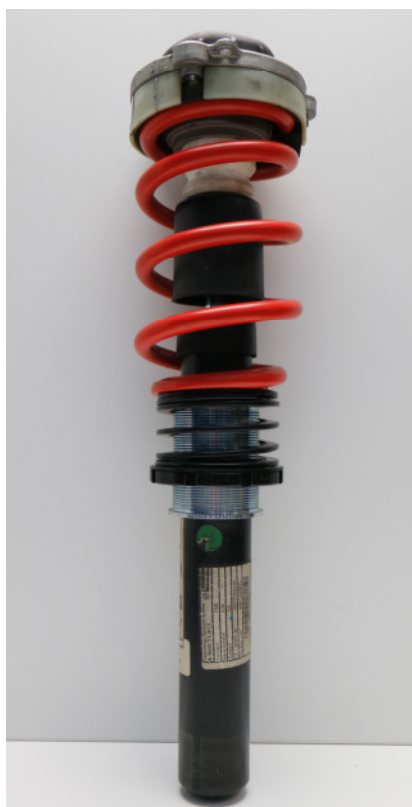
Abb. 3: Feder-Dämpfer-Einheit komplett Fig. 3: Complete spring-damper-unit
