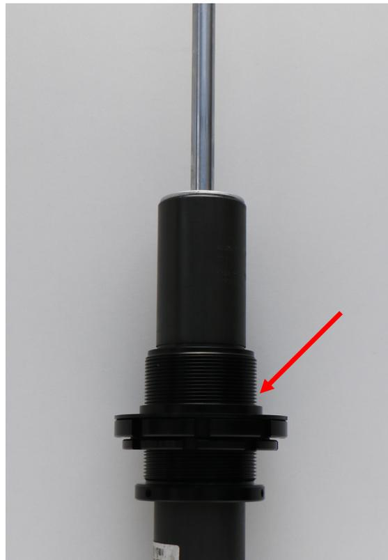
**Abb. 8:** Höhenverstellung montieren
