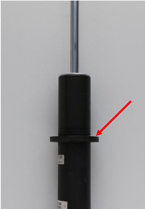
**Abb. 6:** Federteller demontieren
