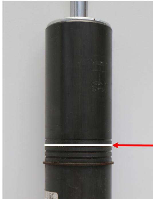
**Abb. 7:** Sprengring in Nut 2 von 5 montieren
