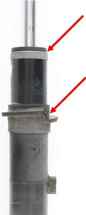
Abb. 1: Abdeckkappe und Federteller demontieren
