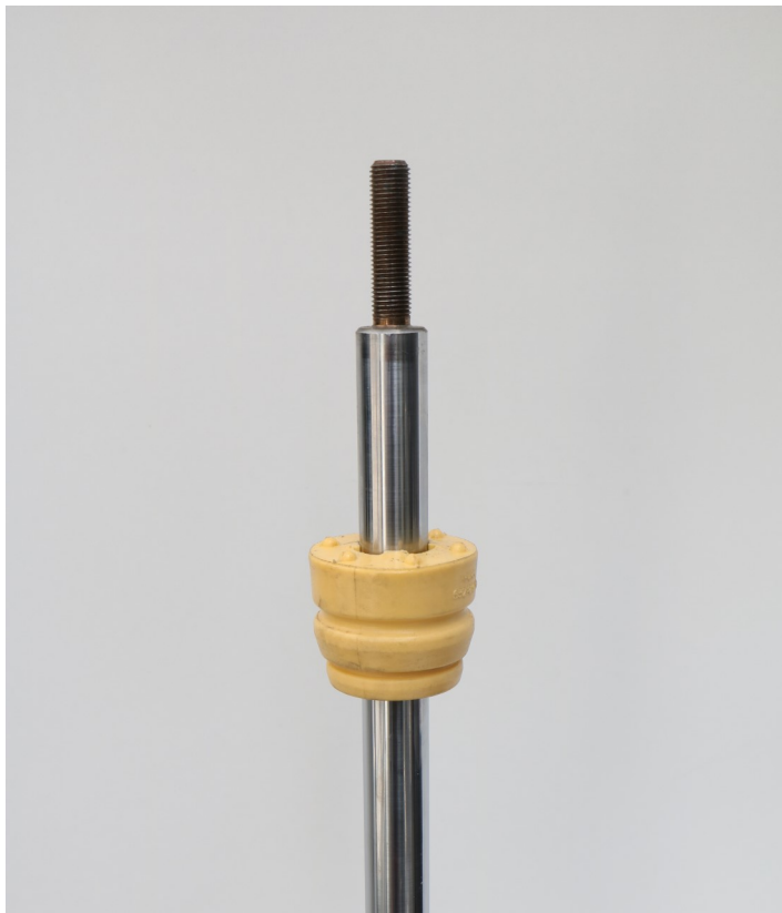
Abb. 1: H&R Anschlagpuffer montieren
