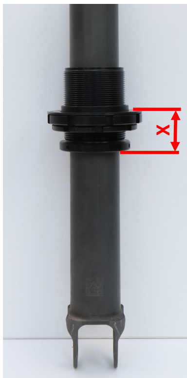
Abb. 6: Einstellmaß X HA (Abbildung ähnlich) Fig. 6: Adjustment dimension X RA (Fig. may vary)
