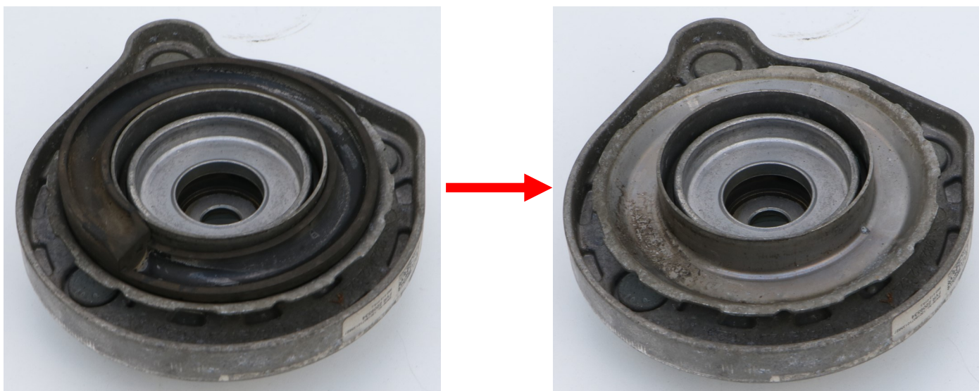
Abb. 1: Das Federschlossgummi wird durch die Höhenverstellung ersetzt
