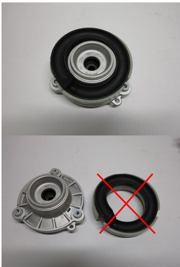
Abb. 1: OE Federteller oben entfällt (Abb. ähnlich) Fig. 1: Do not reuse top spring pad FA (Fig. may vary)
