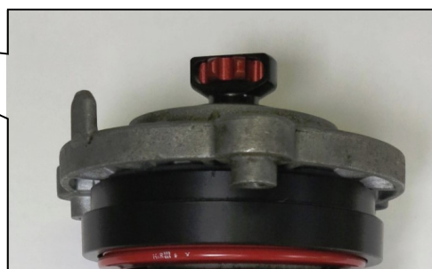
Abb. 4: Dämpfungskraft Verstelleinheit VA Fig. 4: Damping force adjustment FA
