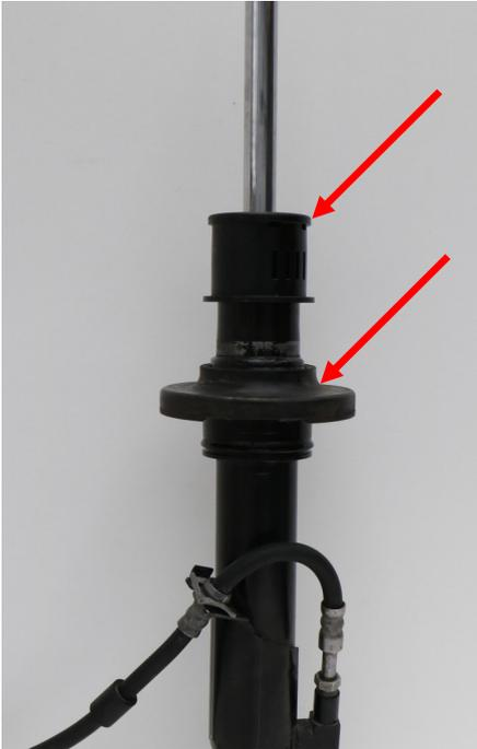
**Abb. 1:** Abdeckkappe und Federteller demontieren
