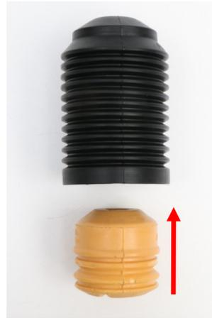
**Abb. 5:** Schutzrohr inkl. Anschlagpuffer auf den Dämpfer aufstecken
