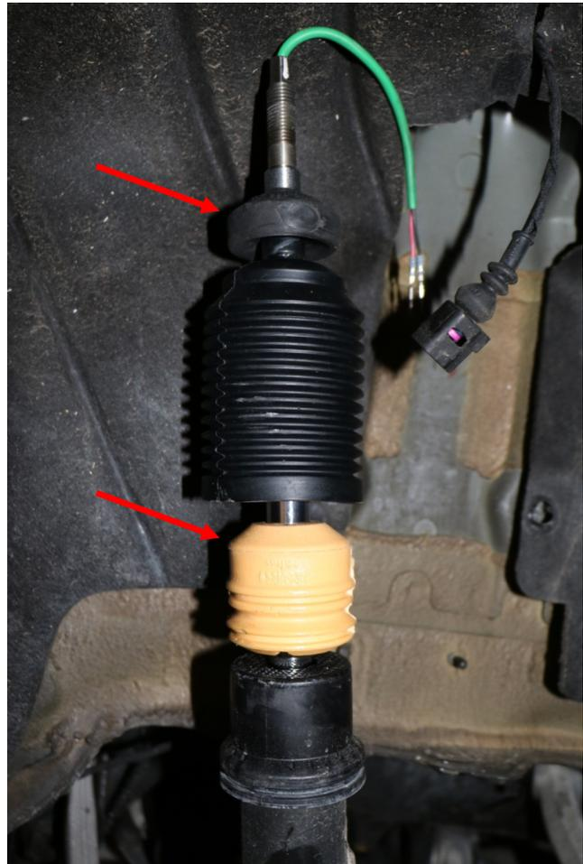
**Abb. 8:** Anschlagpuffer und Schutzrohr mont.
