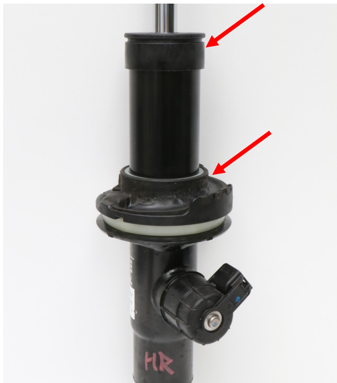
Abb. 6: Abdeckkappe und Federunterlage demont.
