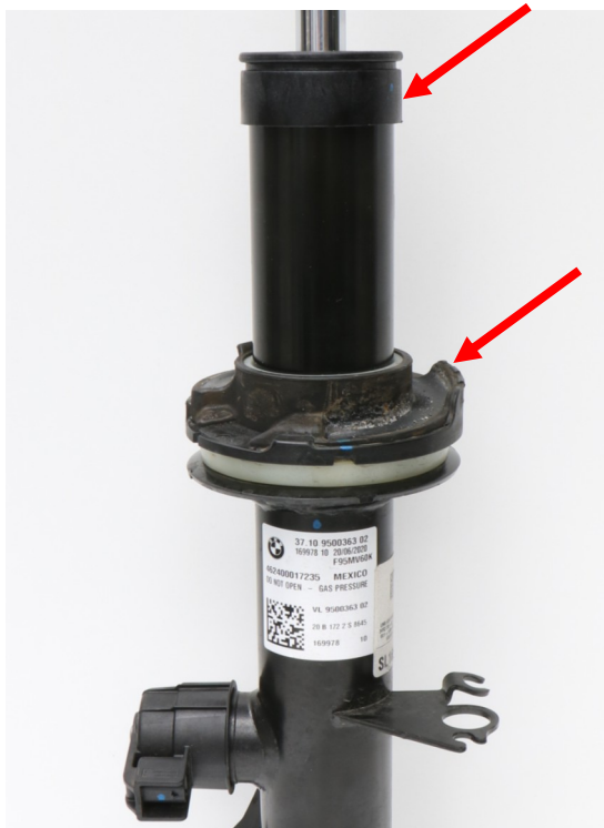
Abb. 1: Abdeckkappe und Federunterlage demont.
