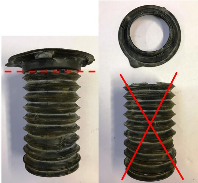
**Abb.2:** OE VA-Schutzrohr wie oben gezeigt kürzen
