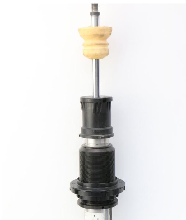
**Abb. 4:** Höhenverstellung, Abdeckkappe und Anschlagpuffer montieren
