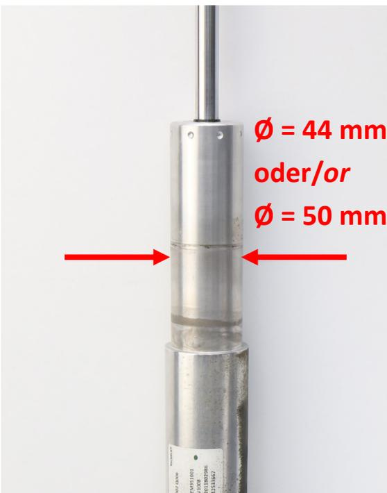
**Abb. 3:** Dämpferdurchmesser kontrollieren
