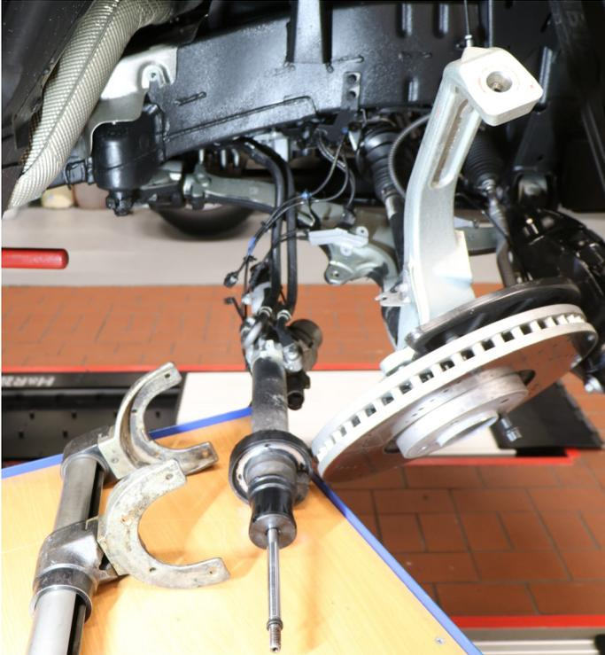
**Abb. 1:** Hydraulikleitungen (ARC) nicht trennen!
