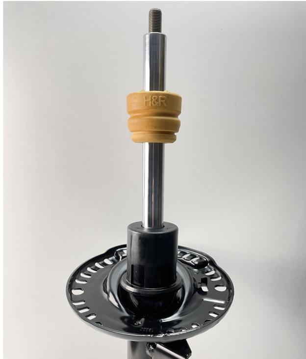
**Abb. 1:** H&R Anschlagpuffer montieren
