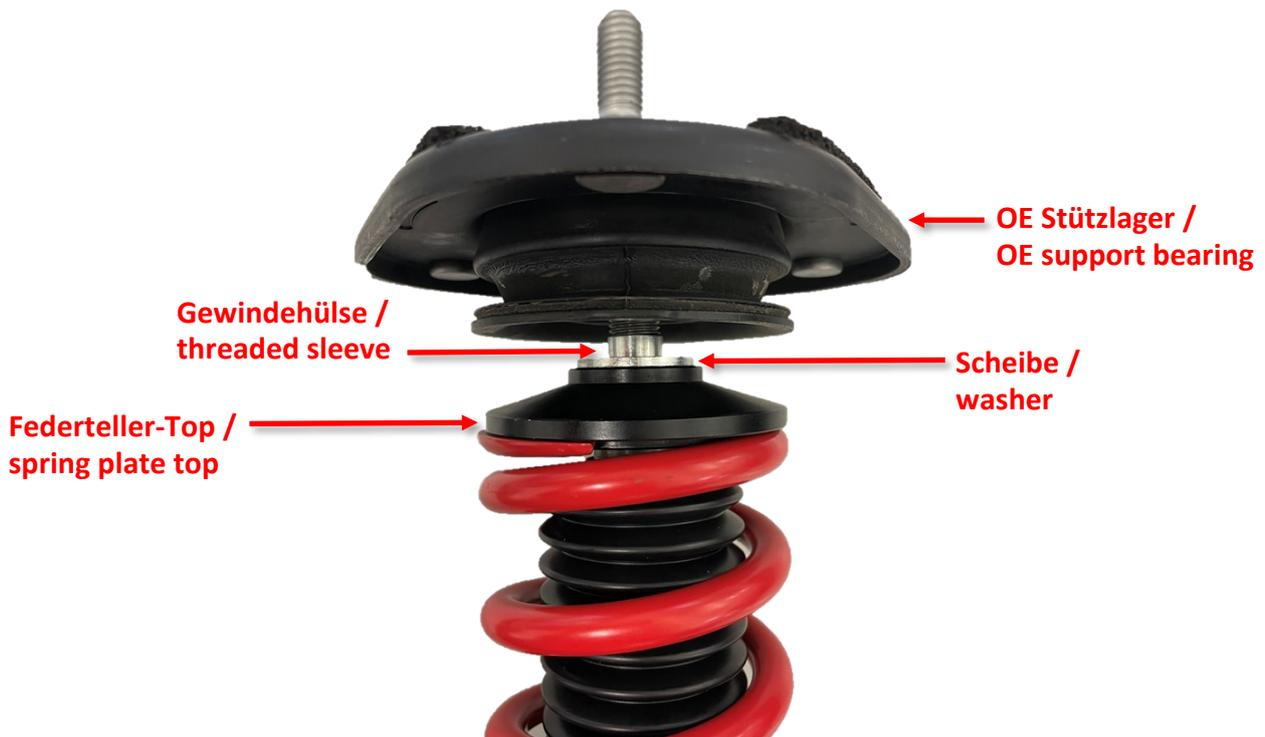
**Abb. 3:** Aufbau VA Stützlager
