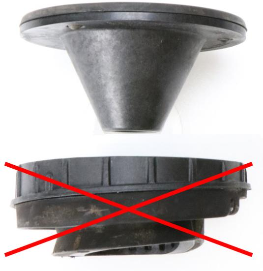
**Abb. 4:** Obere Federunterlage entfällt, Zentrierkegel wird wiederverwendet
