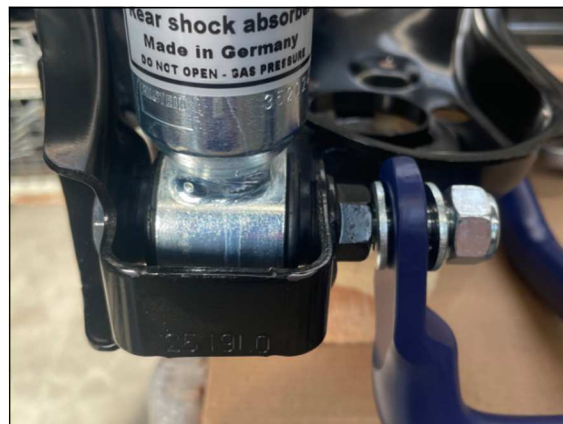
Abb. 2: Befestigung der Stabilisatorenenden
