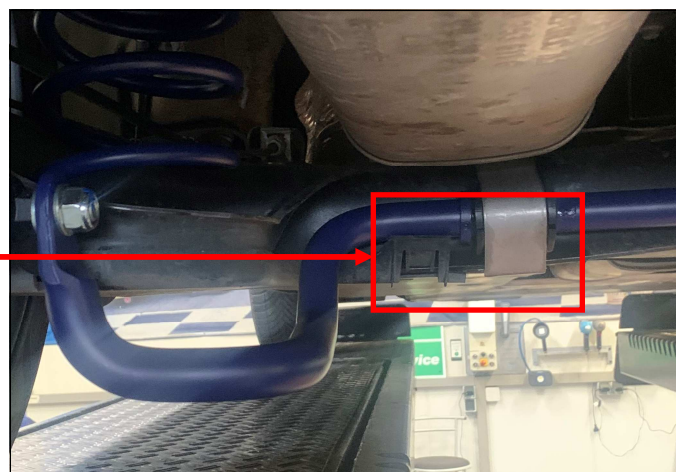
Abb. 5 & 6: Ausklinken des Steinschlagschutzes (fahrzeuginnere Klemmbefestigung wird entfernt)
