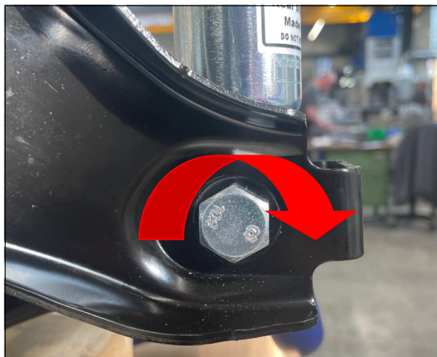
Abb. 10: Anziehen der HA-Stoßdämpferschraube
