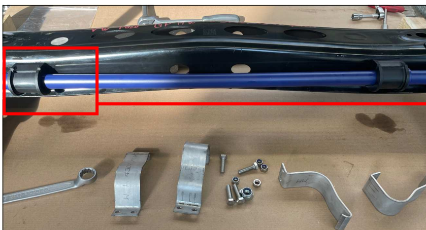
Abb. 3 & 4: Lagergummi Positionierung durch Stellringe
