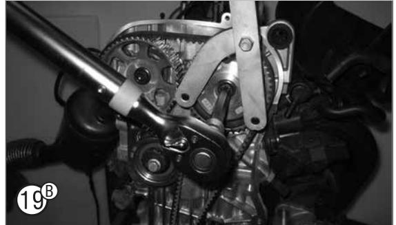
Verwenden Sie ein geeignetes Werkzeug zum Gegenhalten, z. B. den HAZET 2540-2 Nockenwellenrad-Gegenhalter, und ziehen Sie die Zentralschrauben der Nockenwellenräder mit 50 Nm + 90° an.
