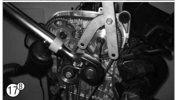
Verwenden Sie zum Gegenhalten der Nockenwellen-Verschraubungen HAZET 2540-2 und ziehen Sie die Zentralschrauben der Nockenwellenräder mit 50 Nm an.
