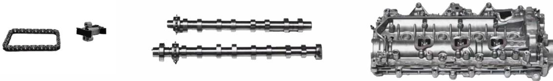
Il est également recommandé d'éviter l'utilisation excessive de mastic d'étanchéité, qui peut obstruer les trous de passage de l'huile, entraînant une mauvaise lubrification et un risque de rupture du tendeur et/ou de la chaîne.
