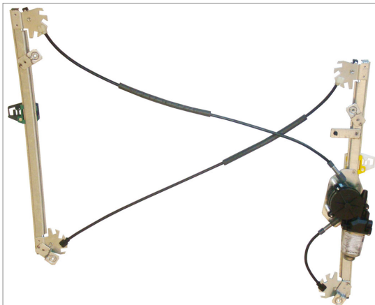
POWER WINDOW LEFT ALZACRISTALLI ELETTRICO SX
