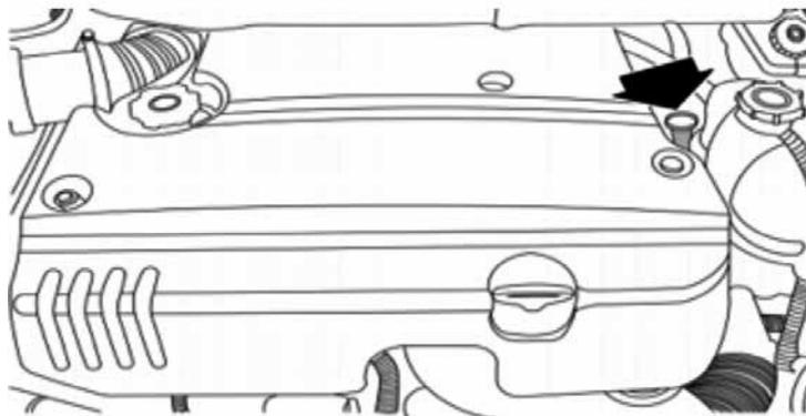
**4** Llenamos con 2 litros aproximadamente y arrancamos el motor para ir añadiendo el atf hasta tener el nivel correcto (comprobar el nivel cuando la temperatura de funcionamiento alcance los 80° aproximadamente )
