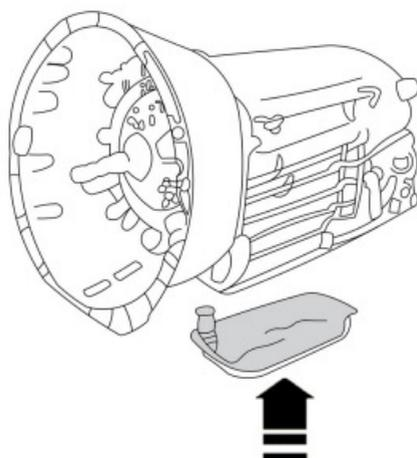
**5** Colocar la junta del carter nueva y volver a montarlo con el tapón de vacío
