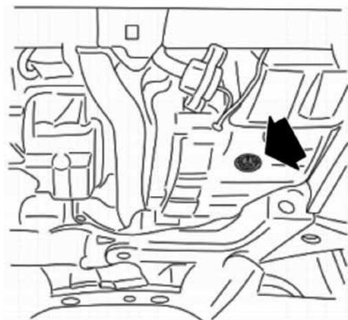
**6** En la parte superior localizamos el tubo de llenado y nivel
