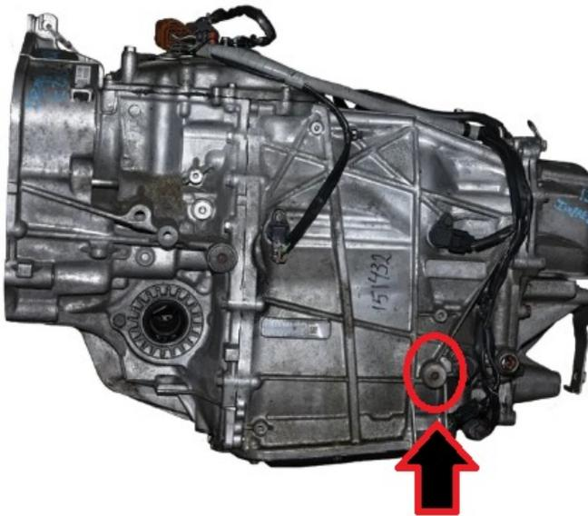
**6** Arrancar el motor y sin pararlo, continuar con el llenado hasta que salga un hilo fino de aceite (es muy importante que la temperatura de funcionamiento no supere los 40°).
