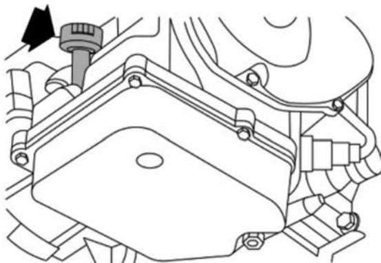
**7** Llenar con el motor parado hasta que salga el atf por el tapón de vacío y arrancar el motor sin pararlo para continuar con el llenado hasta que salga de nuevo un hilo fino por el tapón de vacío (importante que la temperatura no supere los 40° de funcionamiento)
