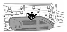
Limpiar el cárter, sustituir los imanes y la junta
