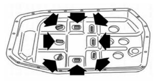
Colocar el cárter de nuevo y el tapón de vacío nuevo
