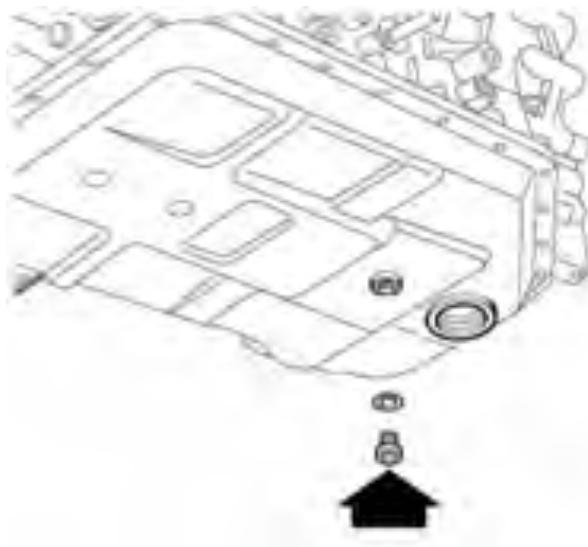
**7** **(ES)** Soltar el tapón de nivel (allen 17mm) situado en el carter y añadir el nuevo ATF con el motor parado hasta que empiece a rebosar.
