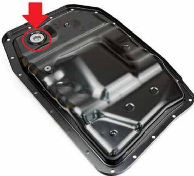
**7** Arrancar el motor y sin pararlo continuar con el llenado hasta que salga un hilo fino de aceite atf, volver a montar el tapón de llenado/nivel (par de apriete 80nm). Es muy importante que la temperatura de funcionamiento no supere los 40°.
