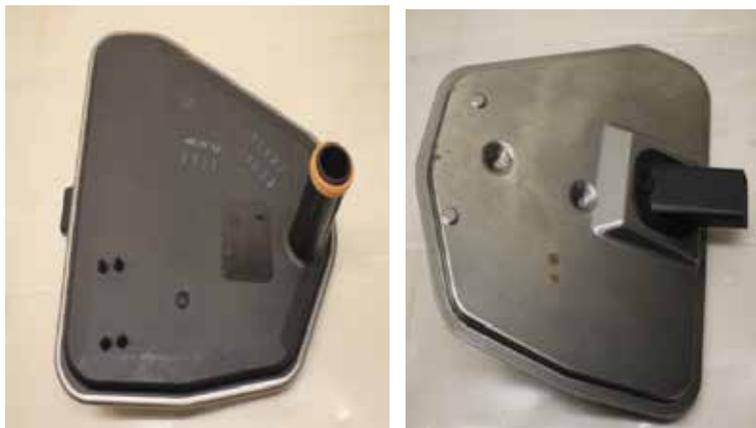
**4** Limpiar el cárter, colocar la junta, los imanes y el tapón de vaciado nuevos (par de apriete 12nm).
