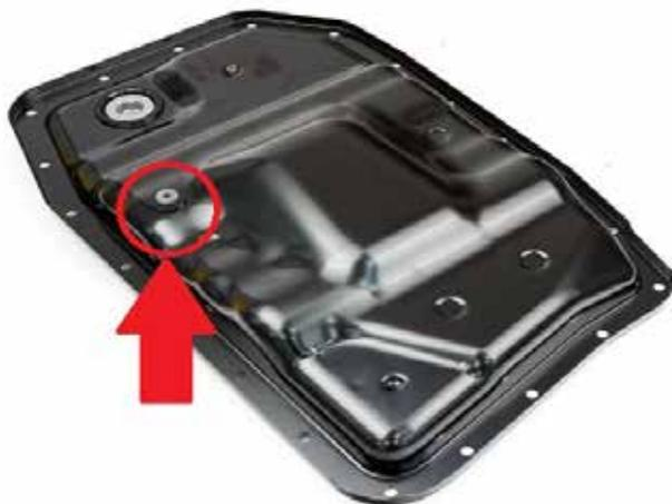
**2** Desmontar el cárter sacando los 21 tornillos.
