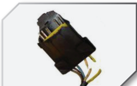
10. Conector deteriorat sau spart
