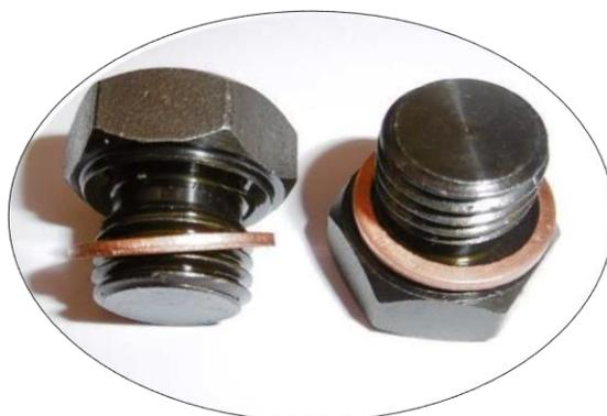
Cet ensemble sert à condamner les orifices de prise d'eau sur le bloc moteur après le démontage des durites.
