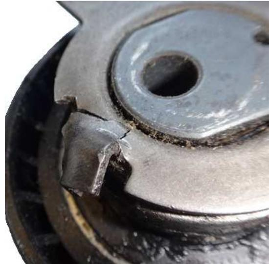
La courroie étant sous-tendue, elle glisse sur les galets et un effort hors cahier des charges est appliqué sur la denture d'où les coupures à la base des dents, occasionnant un décalage de la distribution.
