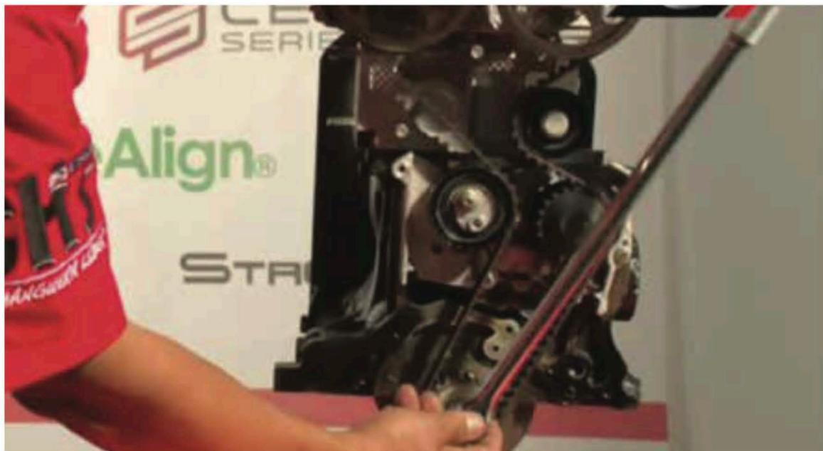
**10.** Asegúrese que los índices en los engranes continúan alineados, si no es así, repita el proceso de tensado de la banda haciendo coincidir los índices del tensor. Coloque las tapas del motor.
